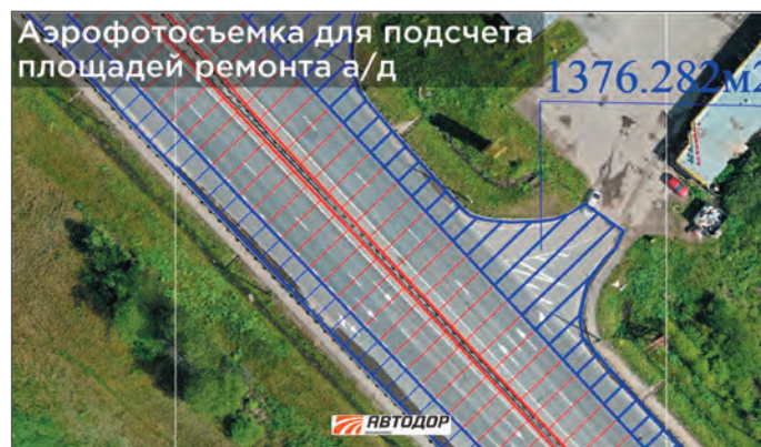
Рис. 6. Подсчет площадей ремонта асфальтового покрытия
