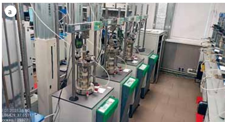
Рис. 12. Контроль оснащенности испытательных лабораторий: а) приборы для испытаний методом трехосного сжатия; б) автоматизированный испытательный комплекс АСИС
