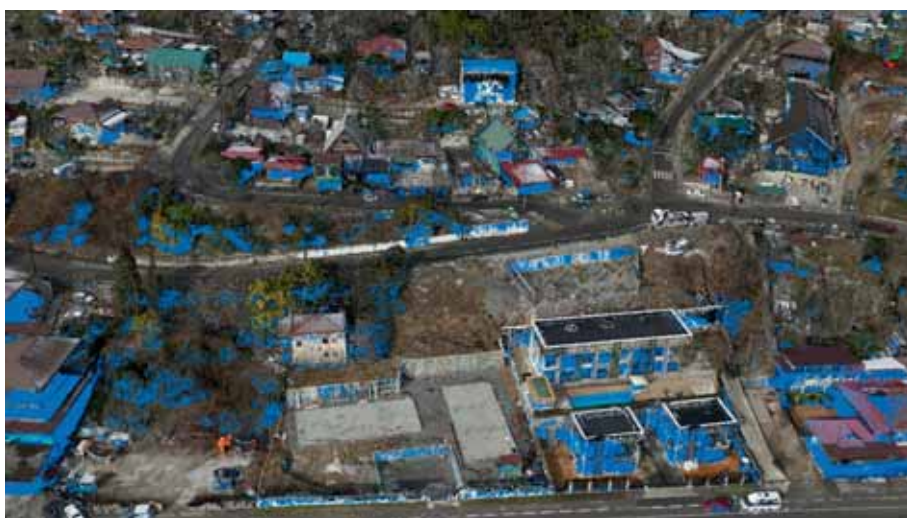
Рис. 3. Плотное облако точек на участке застроенной территории, полученное по результатам воздушного лазерного сканирования с БПЛА
