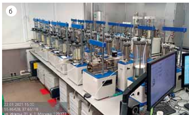
Рис. 12. Контроль оснащенности испытательных лабораторий: а) приборы для испытаний методом трехосного сжатия; б) автоматизированный испытательный комплекс АСИС
