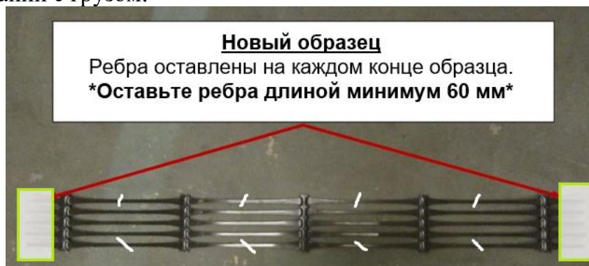
Рисунок 4. Установка образца в зажимы
