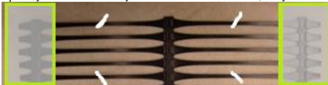
Рисунок 3. Установка образца в зажимы испытательной машины
