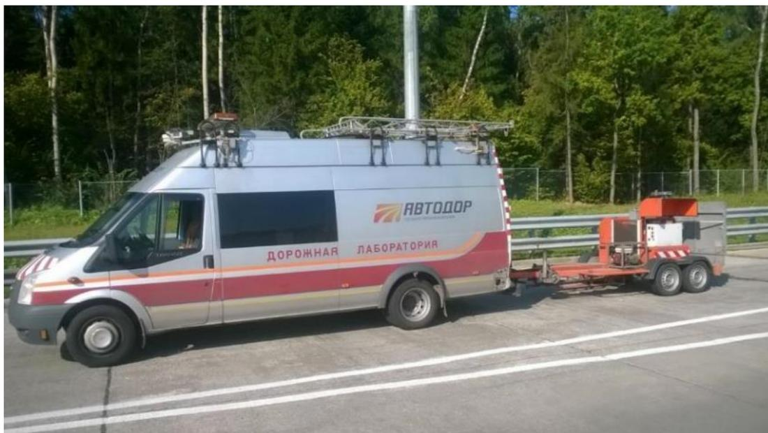
Рисунок 5.1.3 – Проведение измерений на участке установкой FWD «Primax-1500»
